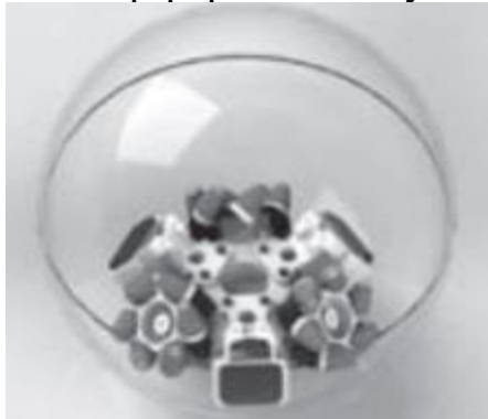
Рис. 1 Сфероробот з внутрішньою платформою, що має три механум-колеса
