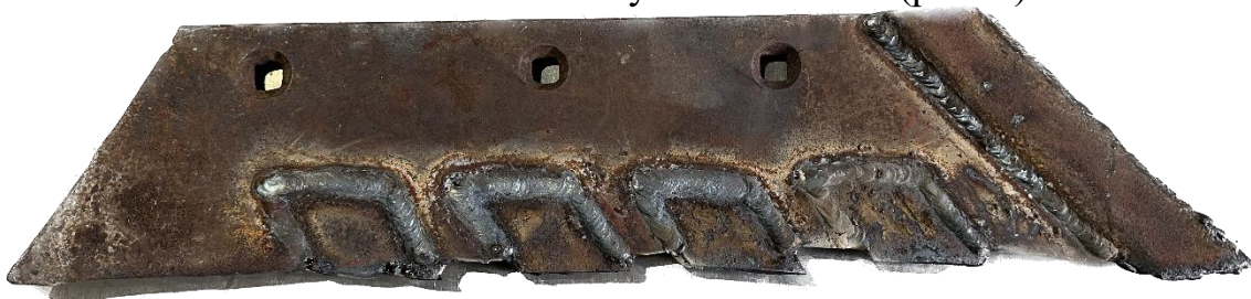
Рис. 3 Плужний леміш з постановкою компенсуючих вставок
