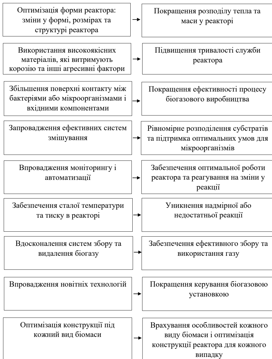
Рис. 1. Шляхи удосконалення конструкцій ферментерів та їх вплив на ефективність роботи біогазових установок
