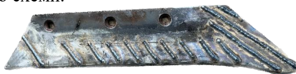
Рисунок 2 – Схема зміцнення леміша
