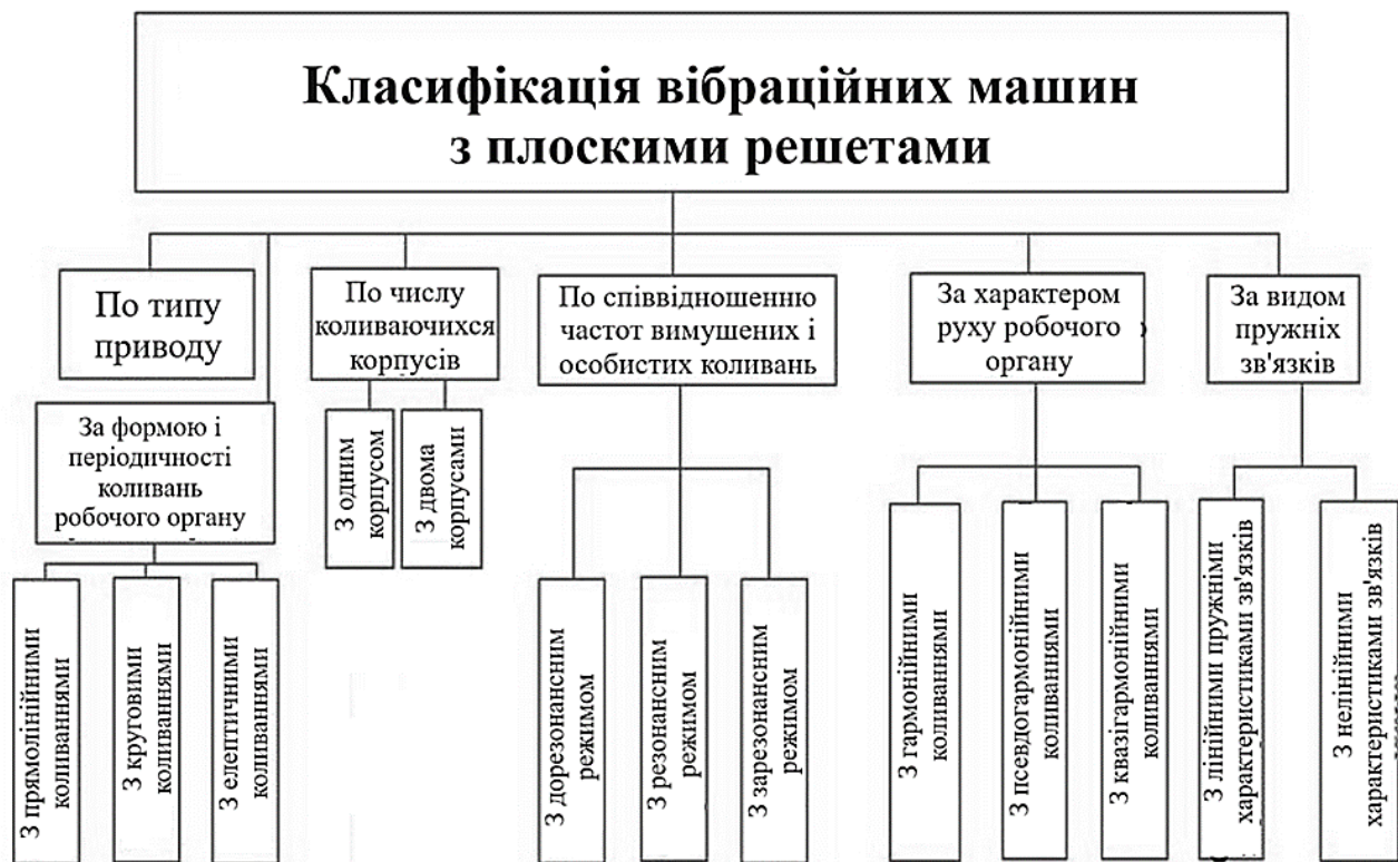
Рисунок 1 – Класифікація вібраційних сепаруючих машин з плоскими ситами
