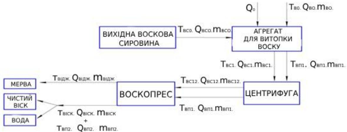
Малюнок 1 – Параметрична модель технологічного процесу витоплення воску з рамок із восковою сировиною.
